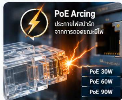
ความร้อนจากการ Arcing ทำให้เกิดรอยไหม้ และเขม่าดำที่หน้าสัมผัส
